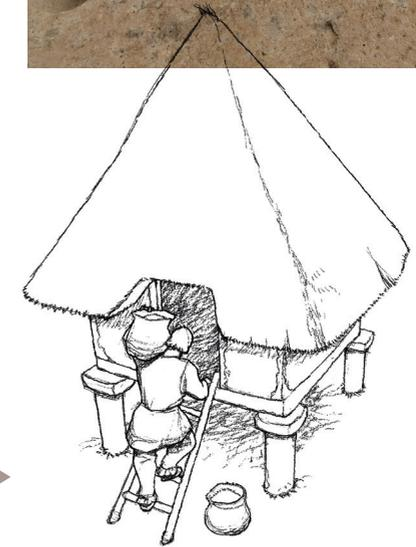
▶ Les greniers étaient montés sur pilotis afin de protéger les stocks de l'humidité et des rongeurs.
